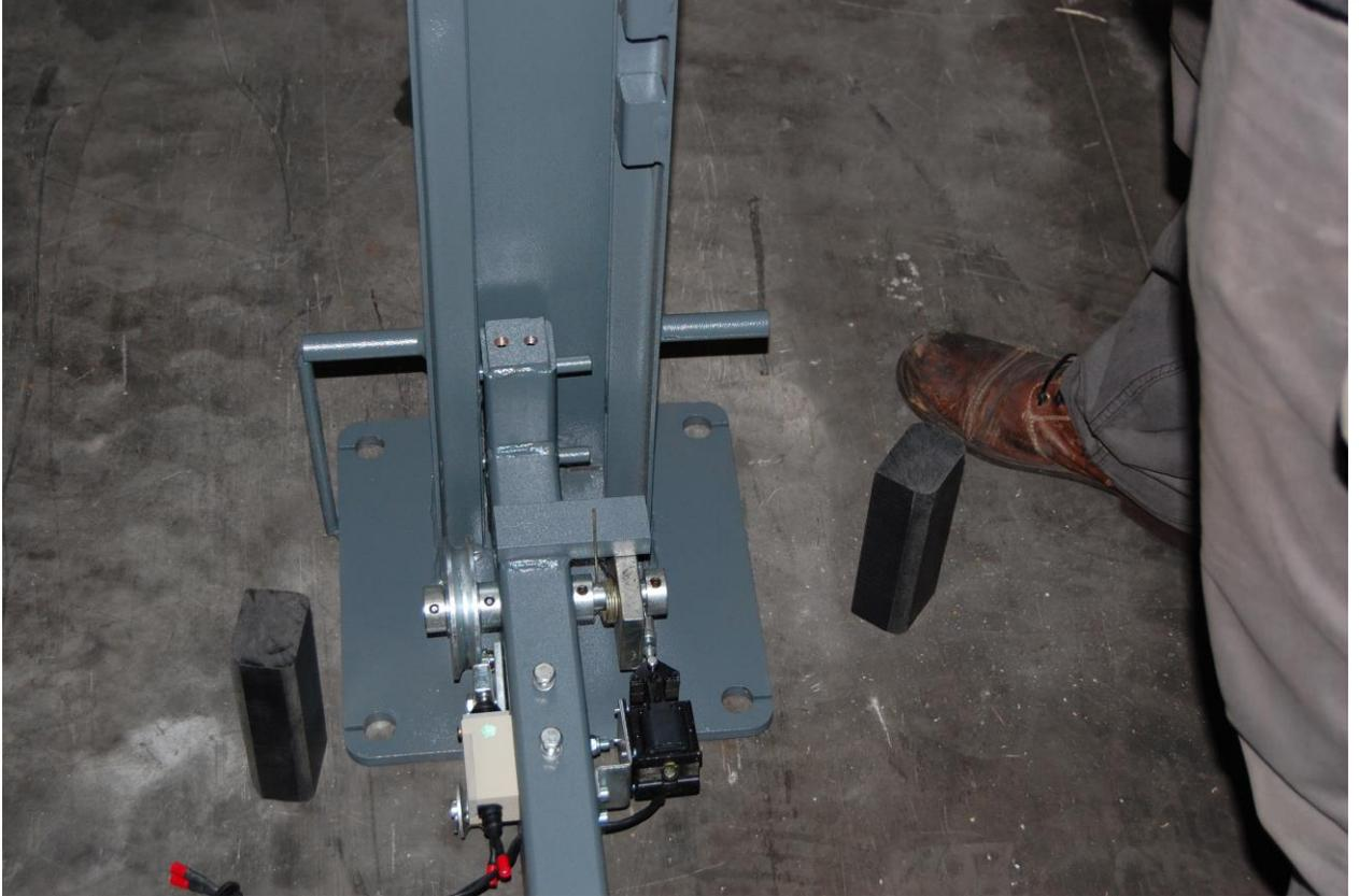
Drehen Sie Säulen über die Stifte an des Querträgers so dass es in der Säule kommt. schieb jetzt die Kunststoff-führungsblöcke mit dem Schlitz nach unten, um die Stifte. Montieren Sie die Sicherungsplatte mit die zwei innensechskantschrauben ,Tun sie dies für alle Säulen .
