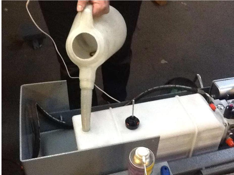
Füllen Sie den Ölbehälter mit 11 Liter Hdrauliköl Viskosität 32
