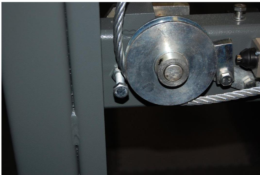
Sichern Sie sie mit beiden Seiten der Querträger eine Mutter. Diese Bolzen stellen sicher dass die Kabel nicht von den Rädern laufen Tun Sie dies für alle vier Seilrädern
