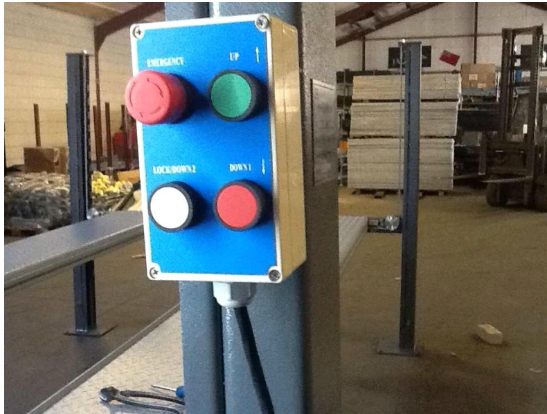
plaats de bedieningskast op de paal
